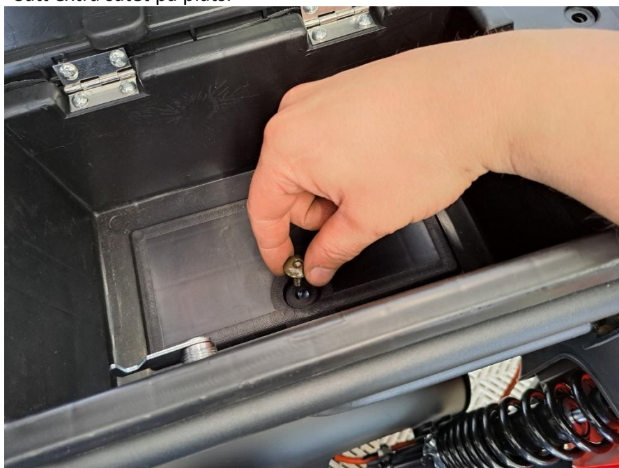
Montera extra sätet med 5 mm insexbultar och 10 mm muttrar.
