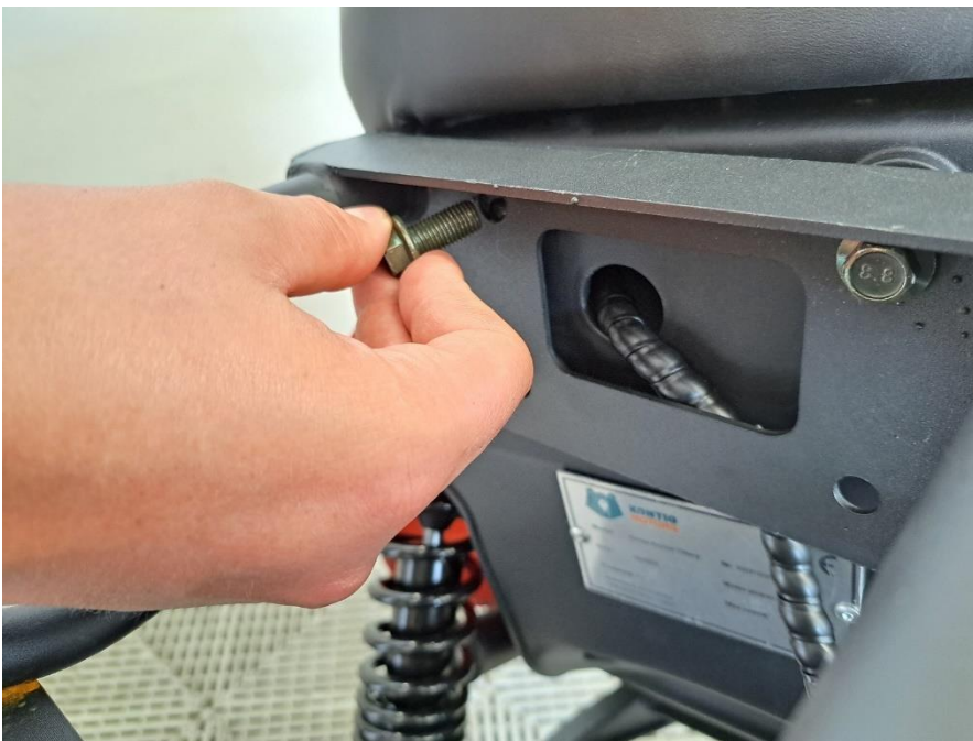
Fäst extra sätets stomme med 12 mm bultar.
