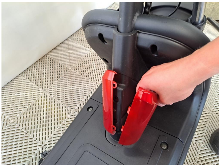
Sätt fotutrymmets dekorationsplast på plats.
