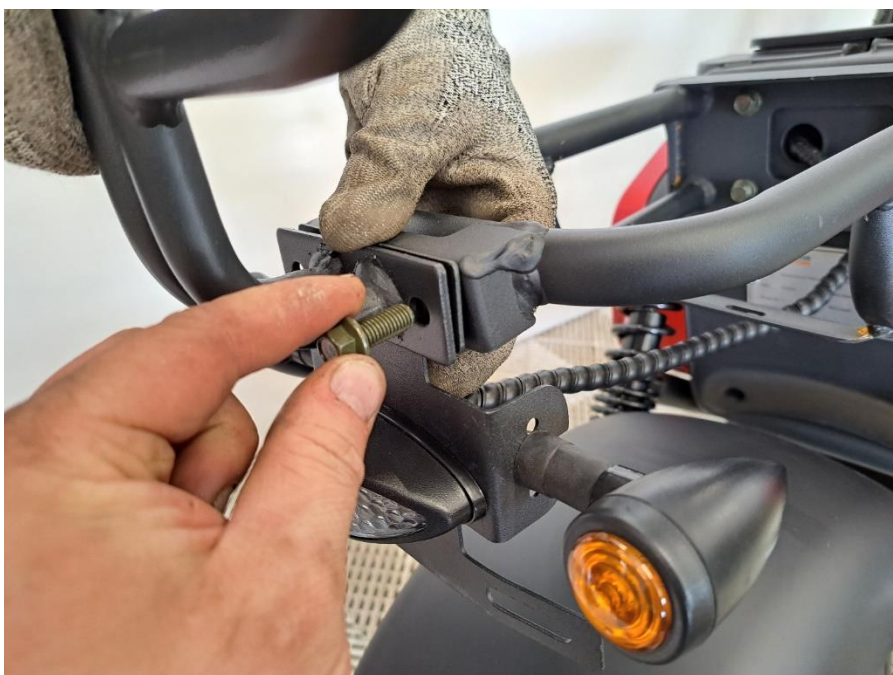
Fäst ryggstödet och bakljuset med 10 mm bultar.
