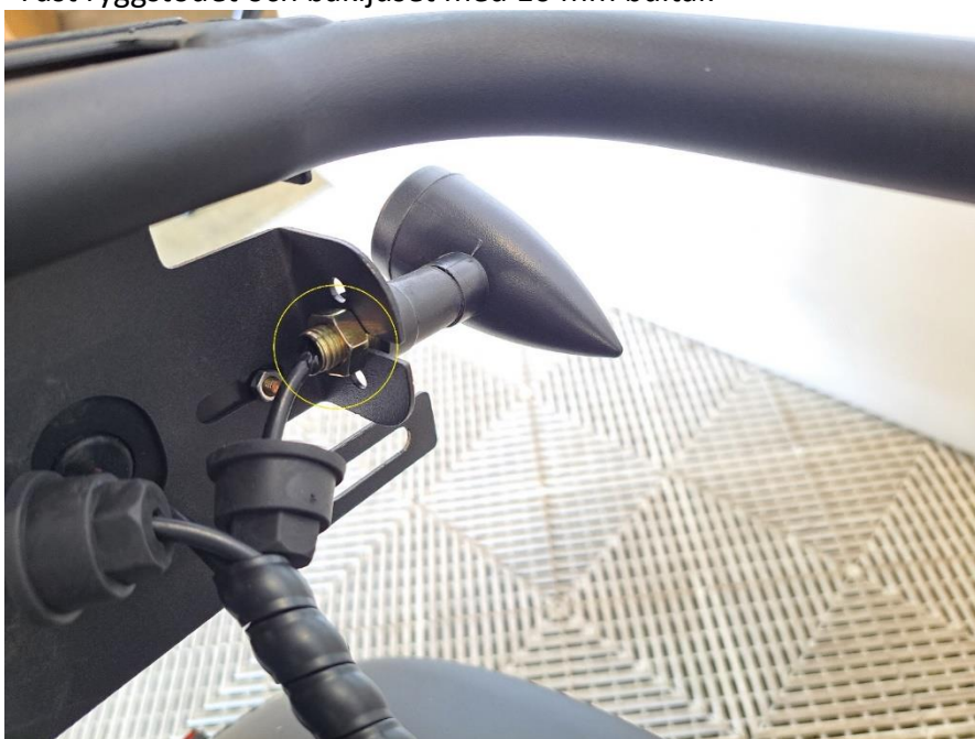
Dra åt de bakre blinkers 14 mm fästmuttrar.
