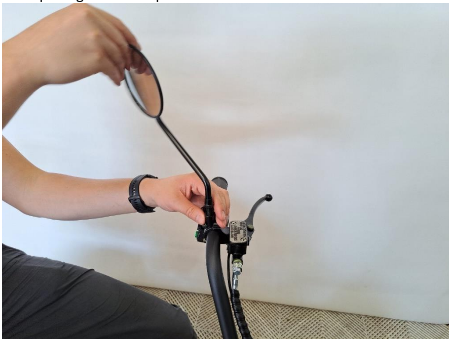
Fäst speglarna genom att vrida dem.
